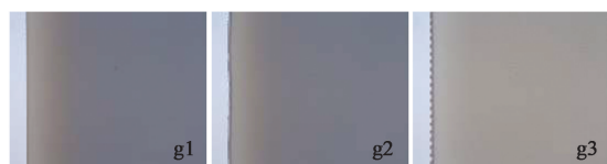
图10 样品 g1~g3 的固含量测试膜面情况
